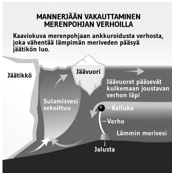
KUVA 2 Mannerjäätikön vakauttaminen merenpohjan verhoilla (kuva Arktinen keskus, Lapin yliopisto)
