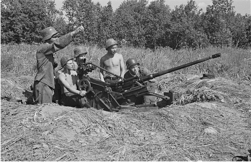
Kuva 4b. Esimerkkikuvat, klusteri 1: SA-kuva 151114: "Ilmatorjuntatykki torjumas- sa vihollisen maataistelukoneitten hyökkäystä Rajakonnun kylän liepeillä. Kuvassa 20 mm:n saksalainen ilmatorjuntatykki 20 ItK 30 BSW vuodelta 1930" (Lähde: FINNA).
