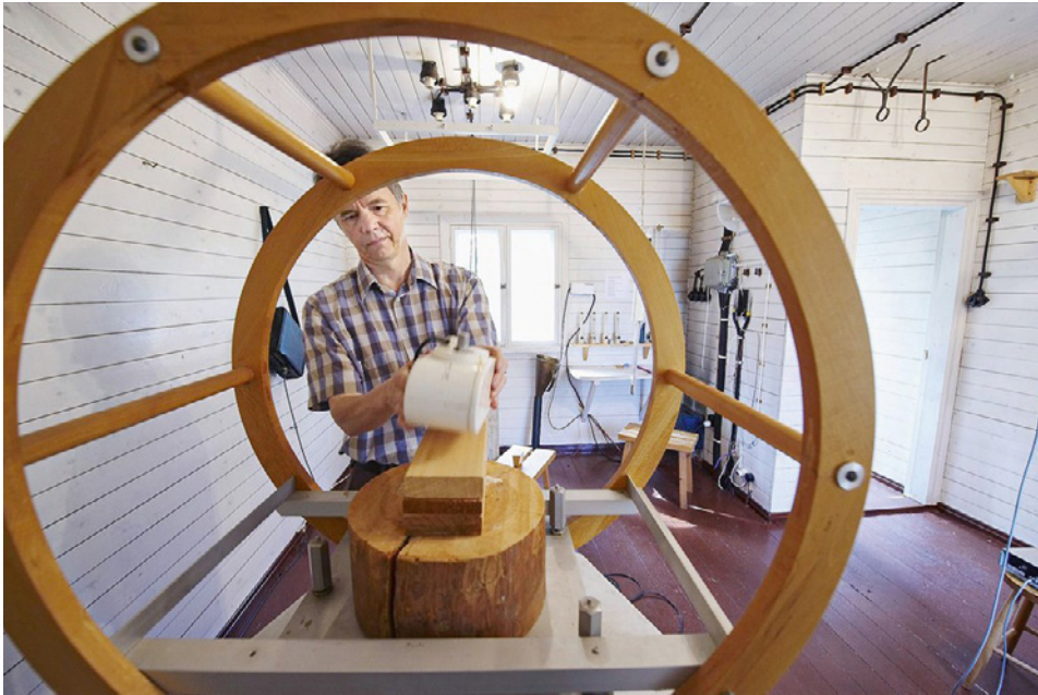
Kuva 72. Nurmijärven geofysiikan observatorion johtaja FT Kari Pajunpää (1956–) tekemässä observatorion magneettisia kalibroitimittauksia protonimagnetometrillä, joka on valkoinen laite Pajunpään käsissä. Kahteen ympyränmuotoiseen kelaan (Helmholtz-kelat 194 ) kierretyt virtajohtimet synnyttävät tasaisen magneettikentän kelojen keskelle (Kuva: Turun Sanomat).
