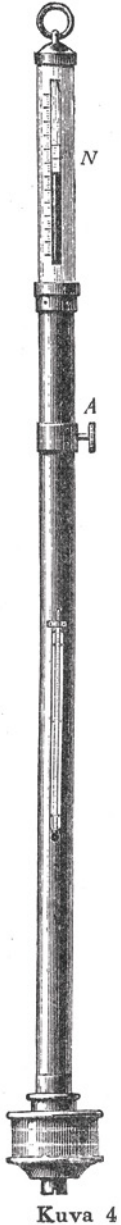
Kuva 97. Fuess-tyyppinen elohopeailmapuntari. Laite oli maailmanlaajuisessa käytössä 1800-luvulta 1900-luvun loppuun saakka. Suomessa Ilmatieteen laitoksen sääasemat oli varustettu kuvan mukaisella niin sanotulla asemailmapuntarilla. Pitkässä putkessa on elohopeapatsas, jonka yläreunasta luetaan tarkkuusasteikon avulla vallitseva ilmanpaine. Laitteessa ilmanpaineen mittana käytetään elohopeapatsaan korkeutta millimetreinä, jolloin normaali-ilmanpaine (merenpinnan tasossa) on 760 mm (Kuva: Angervo, 1948a, 1962).
