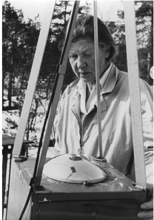
Kuva 74. Ilmatieteen laitoksen all sky -revontulikamera Kevon sääasemalla 1960-luvulla. Laitteessa on puolipallon muotoinen peili, joka heijastaa näkyvän taivaankannen peiliin yläpuolelle sijoitetun kameran linssiin. Kuvassa revontulikameran hoitaja Elsa Käck 196 (1904–1984).
