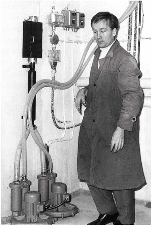
Kuva 76. Rolf Mattsson radioaktiivisuusmittalaitteiden parissa 1970-luvulla Nurmijärven geofysiikan observatoriossa. Kuvassa näkyvät lattialle sijoitetut ilmapumput, joiden kautta radioaktiivisuusnäytteet kerättiin analysoitavaksi (Kuva: Ilmatieteen laitos).
