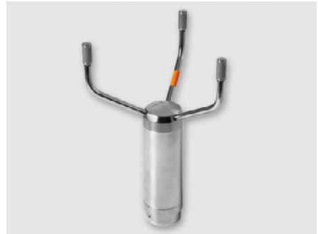
Kuva 104. Vaisala Oyj:n tuottamassa kaupallisessa akustisessa tuulimittarissa on kolme sensoriputkea. Laite tuottaa ultraäänisignaaleja, joiden kulkuajoista voidaan laskea vaakatuulen suunta ja voimakkuus. (Kuva: Vaisala Oyj).
