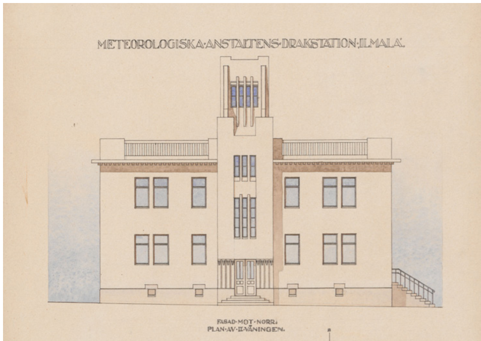
Kuva 39. Rakennuspiirros Ilmalan aerologisen observatorion päärakennuksesta vuodelta 1909. Toteutunut rakennus oli tietyiltä yksityiskohdiltaan erilainen kuin suunniteltu. Yläkerroksiin tehtiin parvekkeet ja yksi lisäkerros rakennettiin 1930-luvun alussa (ks. Kuva 41). Rakennuksessa oli myös johtajan asunto (Kuva: Kansallisarkisto/Rakennushallitus).
