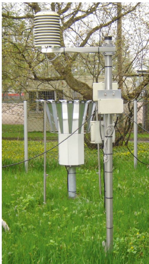
Kuva 96. Ilmatieteen laitoksen Kaisaniemen sääaseman havaintolaitteita. Asema sijaitsee Helsingin yliopiston kasvitieteellisen puutarhan alueella Kaisaniemen urheilukentän vieressä. Etualalla on lämpötilan automaattinen Vaisala Oyj:n valmistama mittalaite, joka rekisteröi ilman lämpötilan. Sensori on sylinterimäisen säteilysuojan sisällä. Sen sisällä on myös elektroninen kosteusanturi. Mittarin takana on sadeveden keräysastia, jota ympäröi Tretjakovin tuulisuojuus (Kuva: Heikki Nevanlinna).
