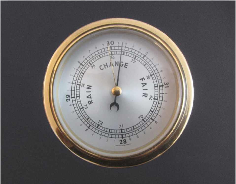
Kuva 98. Kotikäyttöön tai huviveneeseen tarkoitettu aneroidi-ilmapuntari. Siinä paineasteikko on tuumina ja senttimetreinä. Ilmapuntaria voi käyttää omatekoisiin sääennusteisiin, koska ilmanpaine ja sen muutokset liittyvät matala- ja korkeapaineisiin ja niiden liikkeisiin. Karkeasti ottaen nopea pudotus ilmanpaineessa on merkki lähestyvistä matalapaineesta, myrskystä tai saderintamasta, kun taas paineen nousu lupaa poutaa ja aurinkoa (Kuva: Heikki Nevanlinna).
