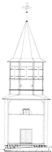
4. TAPULIN ITÄSUUNTAINEN PYSTYLEIKKAUS, 1: 300. Snitt av stapeln mot öster, 1: 300.
