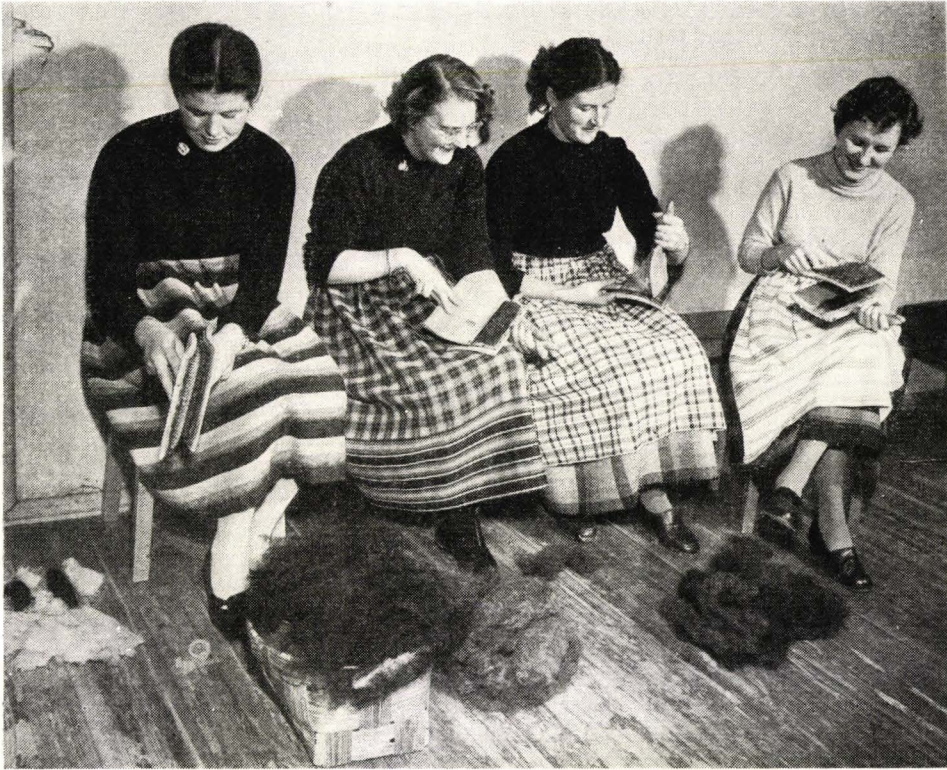
Abb. 13. Stadien des Kardierens: die Wolle wird von einer Kadde auf die andere gekratzt, das eigentliche Kardieren, die Loslösung einer grossen Flocke und das Drehen der Flocke zwischen den Deckeln. Photo Finlandiakuva.
