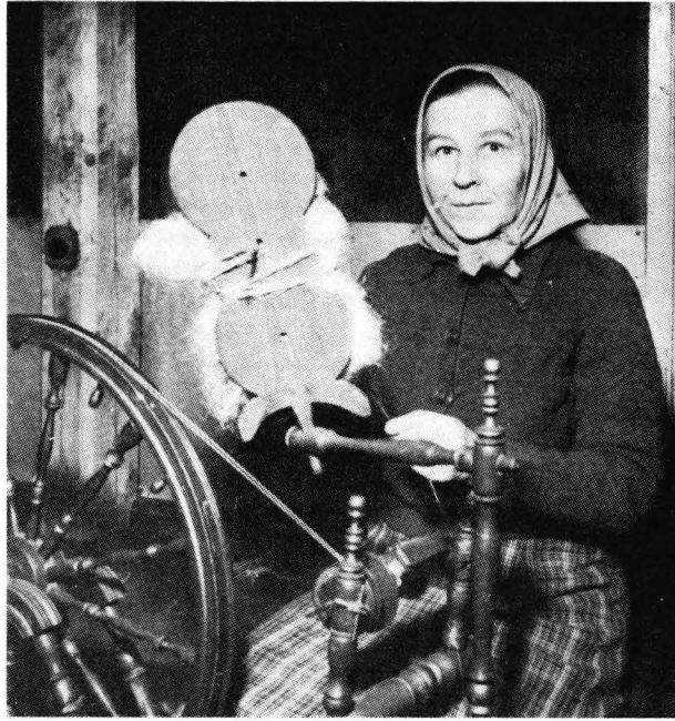
Abb. 69. Der Wocken ist mit Hilfe von Stäbchen und Faden am Wockenblatt festgebunden. Die Bäuerin Hilma Luukkonen vom Bauernhof Ristmäki in Sarajärvi in der Gemeinde Simpele, SKar. Photo Tauno Lautamatti 1954.
