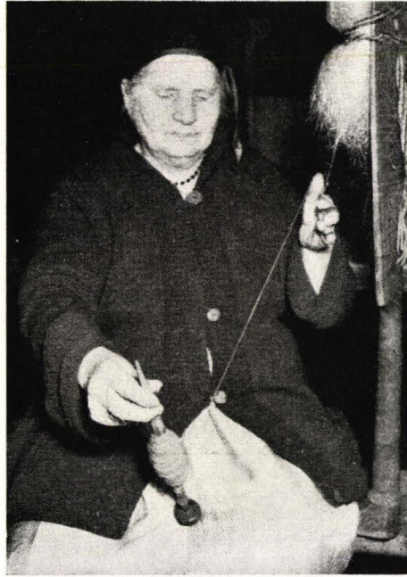
Abb. 82. Die Spinnerin hat den Faden auf die Finger der linken Hand gehaspelt und spult das fertiggewordene Garn auf den Spindelstab, wobei sie die ganze Zeit den Faden straff gespannt hält.
