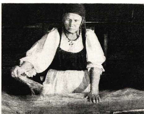
Abb. 28. Der Flachs wird allmählich auf dem Tisch zu einer flachen Platte von über einem Meter Länge ausgebreitet.
