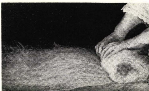
Abb. 30. Dann wird die Platte zu einer lockeren Rolle zusammengedreht, zu einem Wocken.
