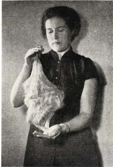
Abb. 20. Die Docke wird durch Gegeneinanderschlagen der Handflächen aufgelöst. Photo Sortila.
