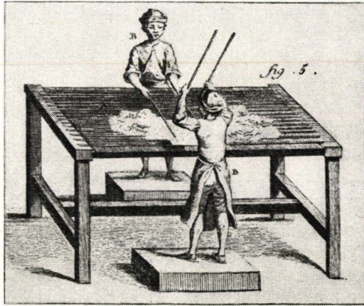
Abb. 9. Das Schlagen mit den Stöcken. Nach der »Encyclopédie, ou dictionnaire raisonné des sciences, des arts et des métiers« von Diderot und d'Alembert.
