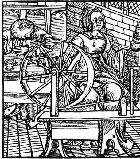
Abb. 110. Spinnrad mit U-förmigem Flügel, nach S. Arndes Kalender 1519. Nach Feldhaus 1914.
