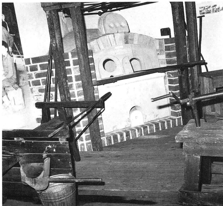
Valokuva 39. Lasitehtaan rekonstruoitu uuni yhden työryhmän kohdalta Karhulan lasimuseossa. Vasemmalla puhaltajan tuoli, triivauspenkki. Valok. O. Nykänen 1966. KTL.
