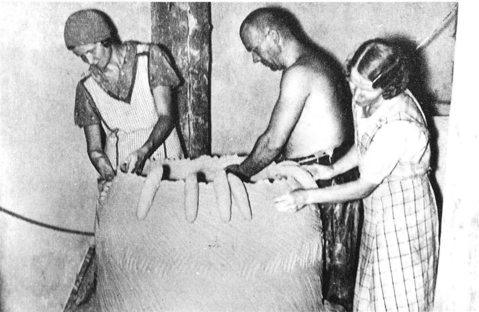
Valokuva 30. Pottumestari apulaisineen valmistaa upokasta Riihimäen Lasi Oy:ssä vuonna 1935. Valok. A. Pietinen. RLA.
