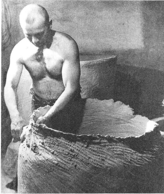
Valokuva 31. Upokas valmistuu Riihimäen Lasi Oy:ssä vuonna 1935. Valok. A. Pietinen. RLA.
