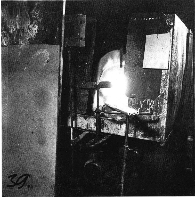
Valokuva 40. Puhalluspillit kuumenemassa uunin suulla. Valok. Matti Oinamo. SLM.
