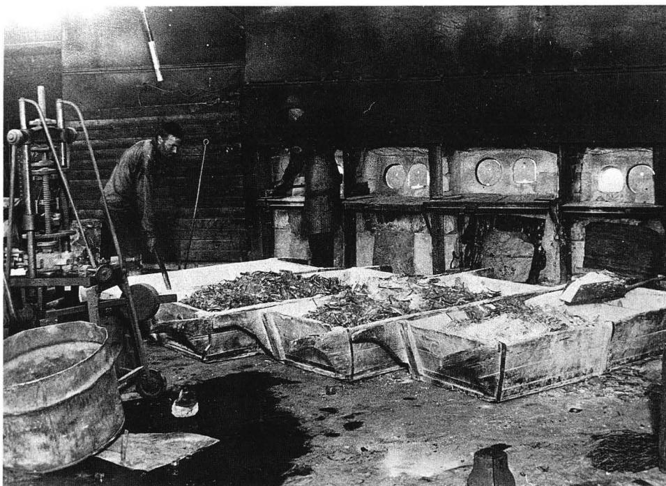
Valokuva 35. Valmiit satsit hytissä sulatusuunin aukkojen edessä. Sulattajan apulainen ahtaa mäksi upokkaksiin. SLM.
