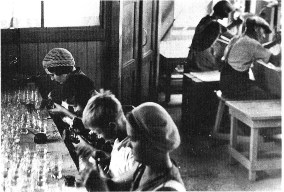
Valokuva 63. Merkkaajat piirtämässä mallikuvioita hiottavien lasien pintaan. SLM.
