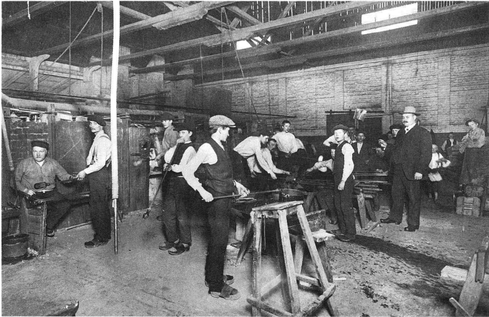
Valokuva 43. Puhallustyöryhmiä Riihimäen Lasi Oy:n hytissä. Edessä hyttipoika velssaa alotusta velssaplootun päällä. Oikealla hyttimestari. MV.
