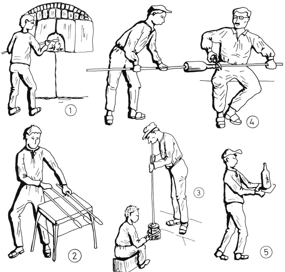
Kuva 4. Puhallustyöryhmä valmistamassa pulloa. Kuvatut työvaiheet ovat: 1. alotus (alottaja), 2. postinhollaus (postinhollaaja), 3. muottiin puhallus (vormupoika ja puhaltaja), 4. katkaisu (punttelipoika ja mestari), 5. jäädytysuuniin kanto (kantopoika).
