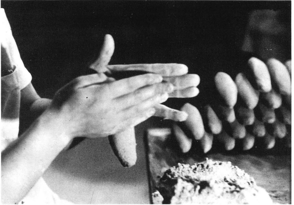
Valokuva 27. Sämpylöitä leivotaan upokasta varten Nuutajärven lasitehtaan savituvassa. NLA.
