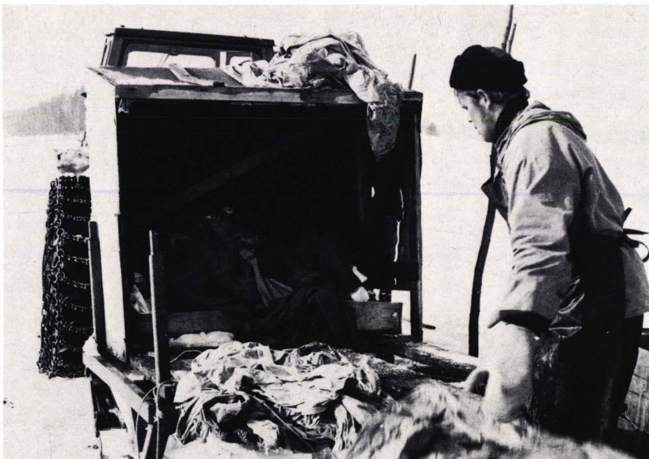
Kuva 62. Kerimäkeläinen »koppiniekkä». Traktorin perässä on teräksinen traktorireki, jonka etuosaan on sijoitettu kovalevystä rakennettu koppi. Koppi suojaa kaloja jäätymiseltä ja lumettumiselta.
