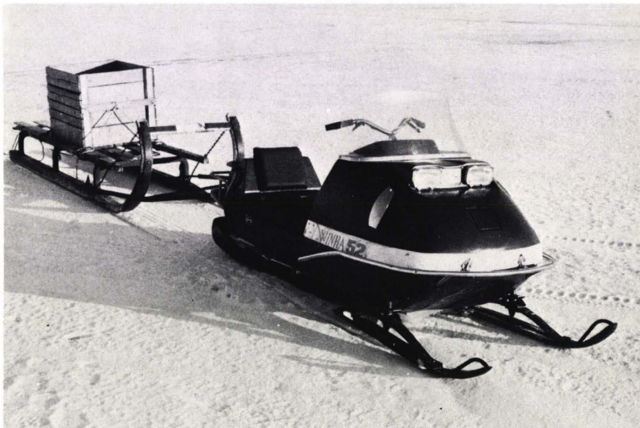
Kuva 63. Nuottamiesten käyttöön kelpaavat vain vahvimmat moottorikelkat, sillä keliolot ovat usein erittäin raskaat esimerkiksi jään pinnalla olevan sohjon vuoksi. Kuvassa olevan moottorikelkan perässä on nytkylaitteen avulla kiinnitettynä kolmikaplainen nuottareki.
